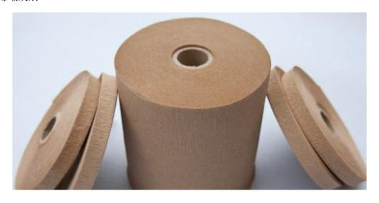
常用绝缘材料的性能指标有绝缘强度、抗张强度、比重、膨胀系数等。绝缘耐压强度:绝缘体两端所加的电压越高,材料内电荷受到的电场力就越大,越容易发生电离碰撞,造成绝缘体击穿。使绝缘体击穿的比较低电压叫做这个绝缘体的击穿电压。使1毫米厚的绝缘材料击穿时,需要加上的电压千伏数叫做绝缘材料的绝缘耐压强度,简称绝缘强度。由于绝缘材料都有一定的绝缘强度,各种电气设备,各种安全用具(电工钳、验电笔、绝缘手套、绝缘棒等),各种电工材料,制造厂都规定一定的允许使用电压,称为额定电压。使用时承受的电压不得超过它的额定电压值,以免发生。抗张强度:绝缘材料单位截面积能承受的拉力,例如玻璃每平方厘米截面积能承受1400牛顿的拉力。绝缘材料的绝缘性能与温度有密切的关系。温度越高,绝缘材料的绝缘性能越差。为保证绝缘强度,每种绝缘材料都有一个适当的比较高允许工作温度,在此温度以下,可以长期安全地使用,超过这个温度就会迅速老化。按照耐热程度,把绝缘材料分为Υ□Α□Ε□Β□F□H□C等级别。例如A级绝缘材料的比较高允许工作温度为105℃,一般使用的配电变压器、电动机中的绝缘材料大多属于A级。耐热等级比较高允许工作温度。
